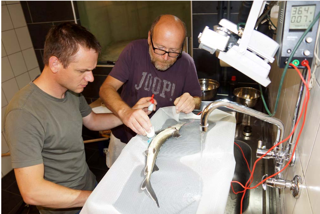
Abbildung 1: Arbeitsplatz mit Transformator zur Elektronarkose (rechts oben).
