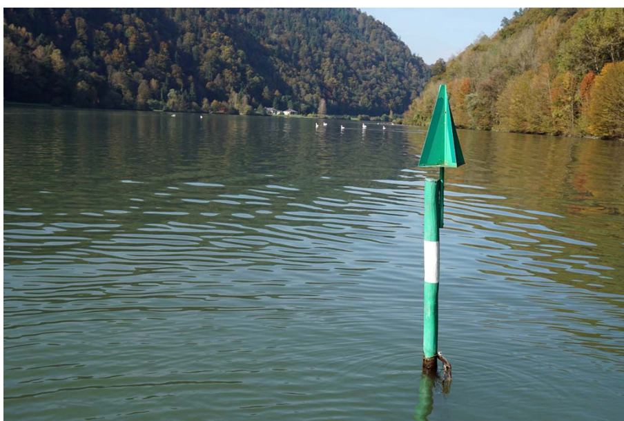
Abbildung 8: Logger Nr. 9, montiert auf einer Spiere im zentralen Staubereich.
