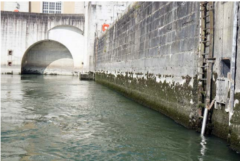
Abbildung 5: Logger Nr. 1 (Rohr rechts im Vordergrund), unterhalb der Turbinen („Saugschlauch“) KW Jochenstein.
